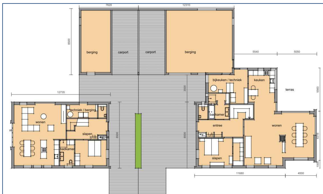
Figuur 4.10: Uitsnede van de situatietekening waaruit blijkt de situering van de nieuwe woning en parkeervoorzieningen op de erfverharding en carports is weergegeven.
