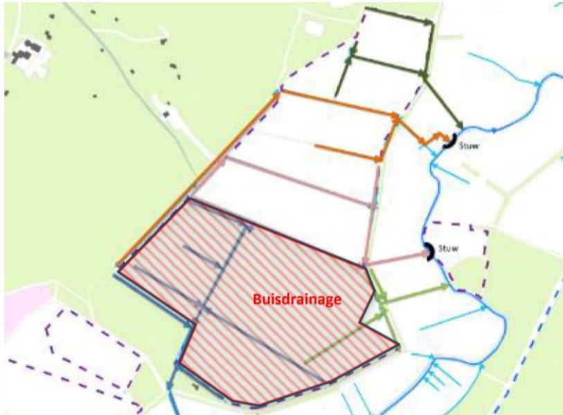
Afbeelding 3.14 Detail huidige afwatering beekdalflank midden tussen Koeweg en Kooidijk: Buisdrainage en 2 stuwen
