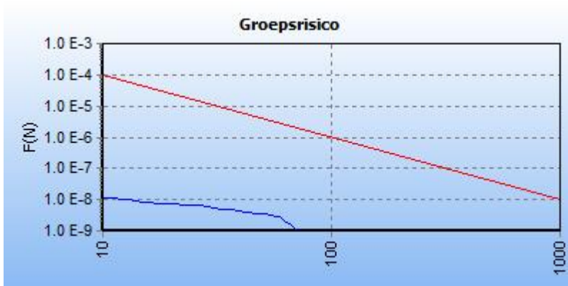
Figuur 5.1 FN curve voor 7626_leiding-A-540-deel-1 van N.V. Nederlandse Gasunie voor de kilometer tussen stationing 2170.00 en stationing 3170.00
